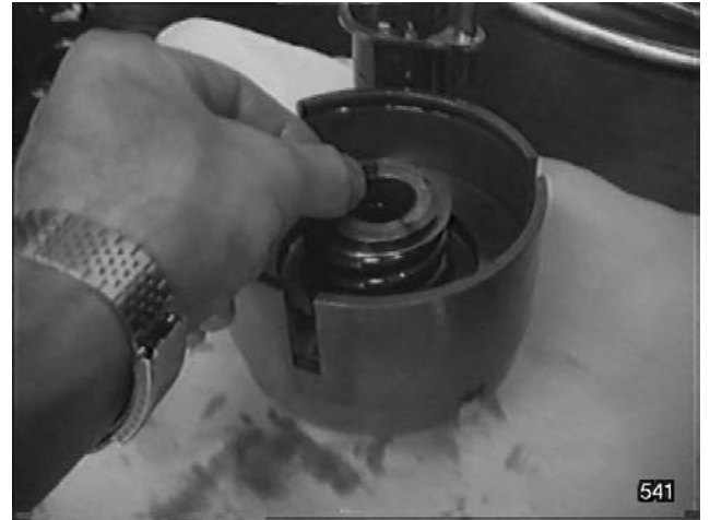
Fig. 27 - Déposer la coupelle entre le ressort et le moyeu porte-disques de l'embrayage.
