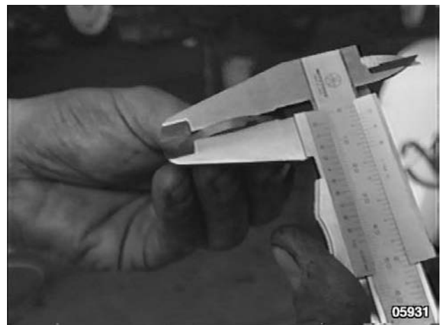
Fig. 65 - Contrôle de l'épaisseur de la cale par un micromètre.
