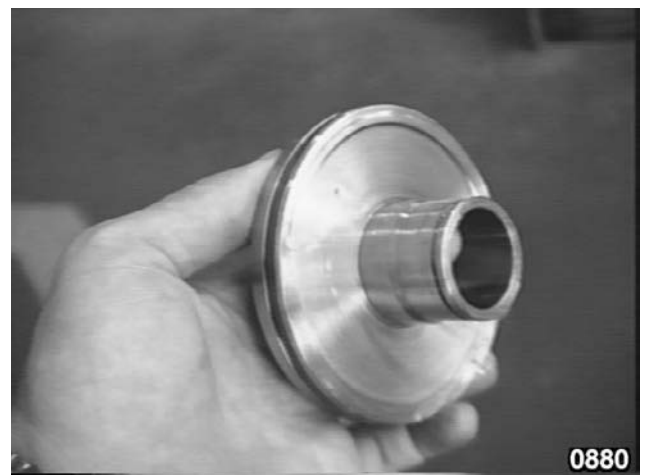
Fig. 64 - Vérifier l'état du joint d'étanchéité du piston de la cloche de l'embrayage de la gamme "LOW".
