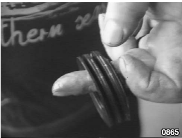
Fig. 61 - Séquence de montage des 5 rondelles Belleville.
