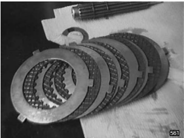
Fig. 28 - Examiner l'état d'usure des disques de l'embrayage.
