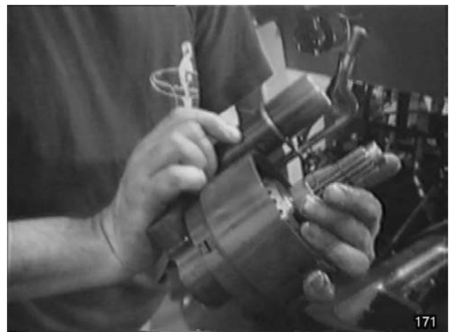
Abb. 19 - Die Ölzulaufleitungen trennen und die Baugruppe Zapfwellen-Kupplung komplett aus dem Getriebegehäuse ausziehen.
