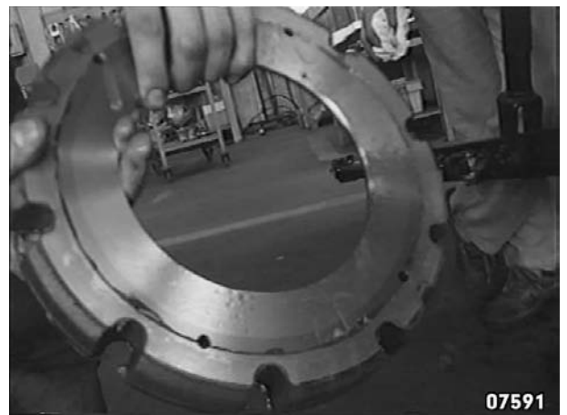
Abb. 13 - Die Ansatzscheibe der Bremsscheibe anbringen. Die gezeigte Seite muss die Bremsscheibe berühren.
