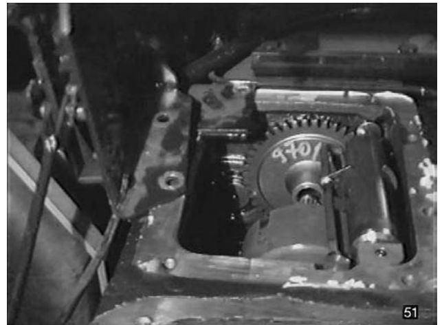
Abb. 17 - Den Seegerring auf der vorderen Kupplungswelle abstreifen.
