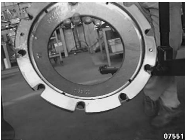
Abb. 14 - Ansicht auf die Seite der Ansatzscheibe, die in Kontakt mit dem Kegelrad des Planetengetriebes anzubringen ist.
