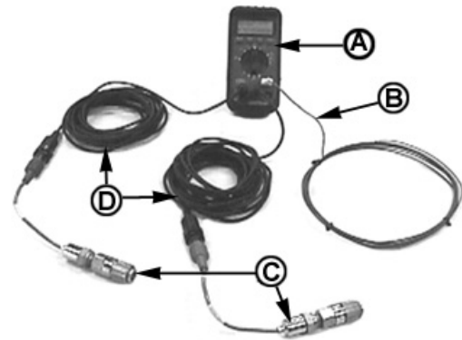
A—Analisador digital de pressão B—Termopar C—Sensores de pressão D—Cabos
