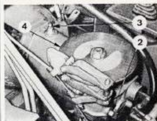
Emplacement des bouchons de niveau et de remplissage sur la boîte de vitesses-inverseur.
