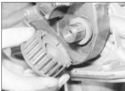
11.20C . . .the crankshaft sprocket . . .
