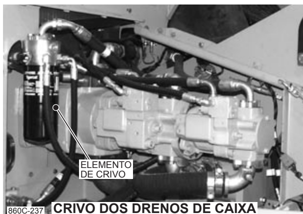
CRIVO DOS DRENOS DE CAIXA
