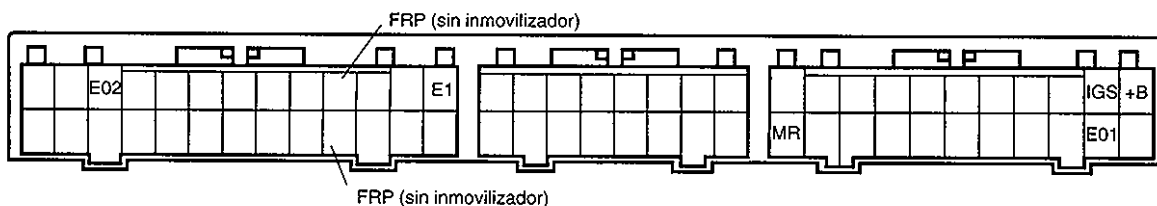
DISPOSICION DE TERMINALES DEL ACOPLADOR DE ECM (VISTO DEL LADO DEL CABLEADO PREFORMADO)
