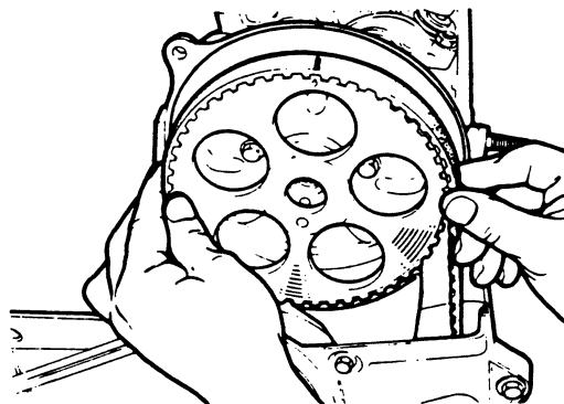
Installing camshaft sprocket (4G33)
