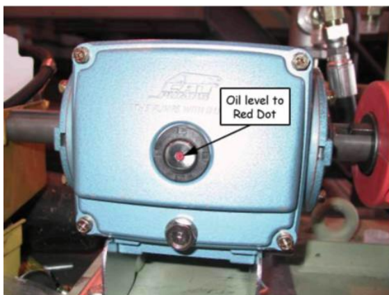
Fig. 9-5 Pompe Cat, niveau d'huile dans la fenêtre de regard d'huile (à l'arrière de la pompe)
