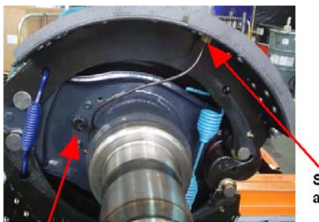
Furo no flange do eixo para passagem do sensor
