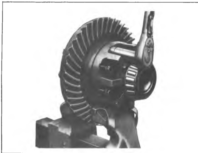
Fig. 3F--Separating Case Halves
