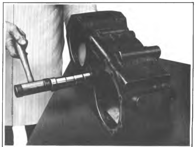
Fig. 7E-13R--Installing Idler Shaft
