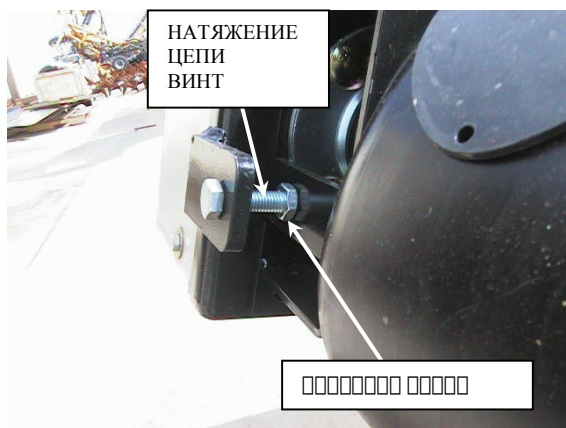
Проверка натяжения цепи
