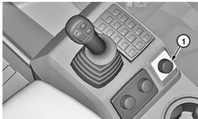
Диск регулировки частоты вращения двигателя
