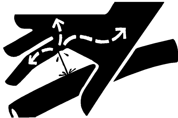
Fuga de líquidos a presión
