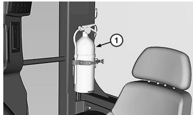
Anbringungsort des Feuerlöschers
