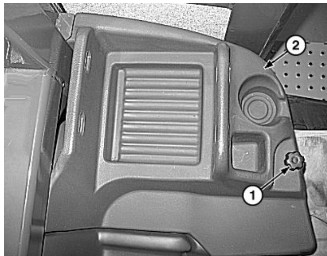
Крышка отсека фильтров
