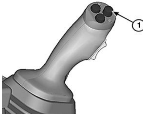
Кнопка гудка на ручке рулевого управления (при наличии)
