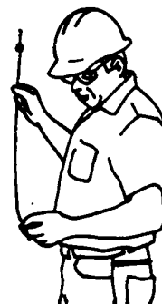
Revisión de aceite en la varilla de nivel
