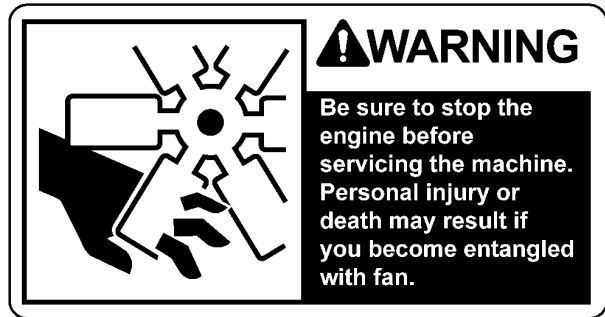
WARNING, Rotating Fan Blade
