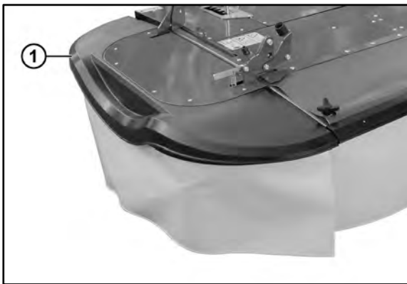
Abb. 21 Protection latérale abaissée
