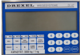
Lastwiegeeinrichtung Liftmaster stacking level control Installation de pesage
