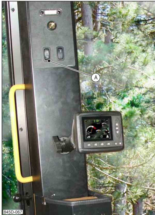
A Toit Électrique Du Compartiment Supérieur – Commutateur
