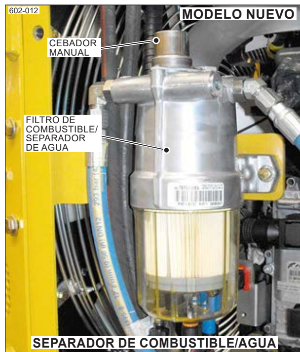
SEPARADOR DE COMBUSTIBLE/AGUA
