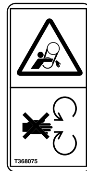
Enredo de la correa del ventilador
