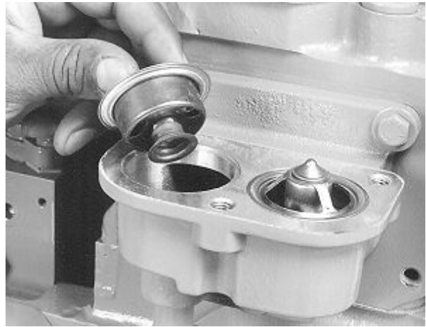
Instalación de termostatos
