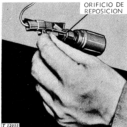
Reconexión del disyuntor de circuito del encendedor de cigarrillos
