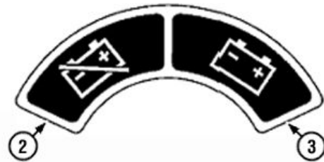
Табличка Размыкающий переключатель аккумуляторных батарей
