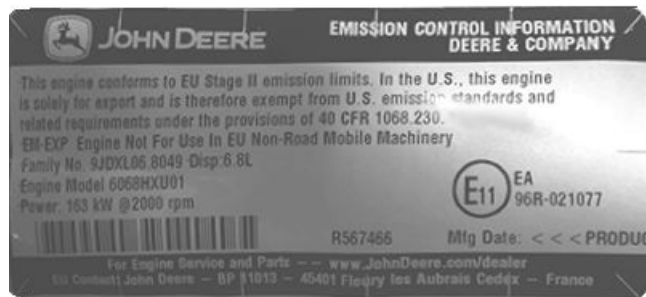
Табличка с информацией о сертификации системы контроля токсичности отработавших газов двигателя
