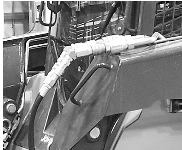
Адаптация погрузчика с бортовым поворотом и высоким расходом к навесному оборудованию со стандартным расходом (погрузчики с бортовым поворотом серии E)
