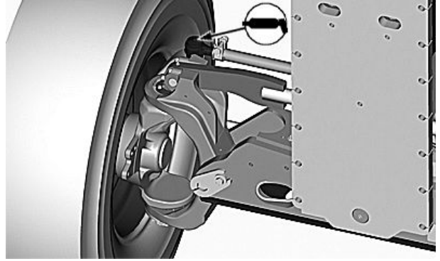
Sin tracción en 6 ruedas—2 puntos de lubricación—(1 en cada lado)
