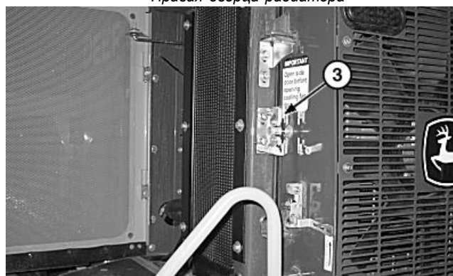
Дверца решетки вентилятора
