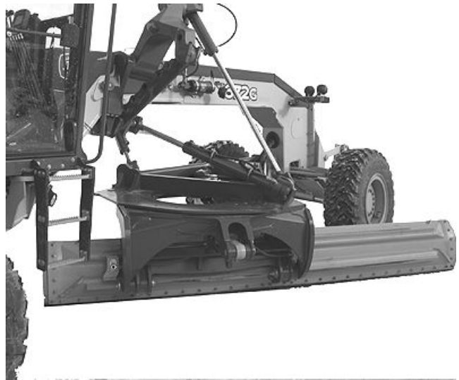
Перемещение отвала в вертикальное положение
