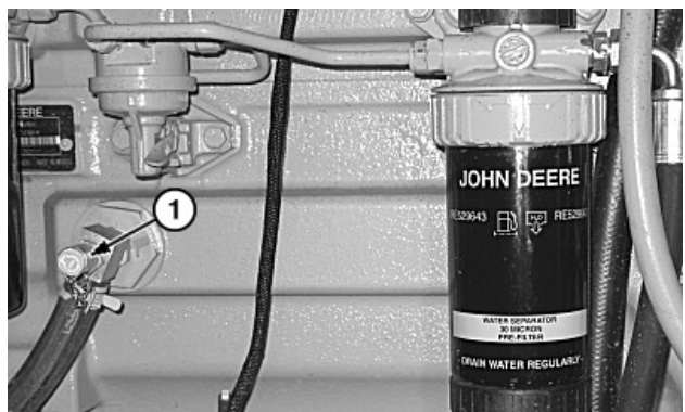
Отверстие для отбора проб охлаждающей жидкости двигателя
