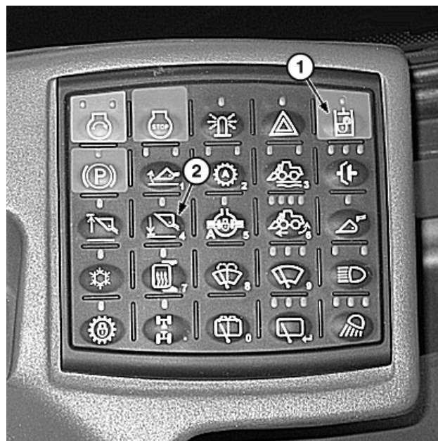
Переключатель возврата в положение переноса (RTC)
