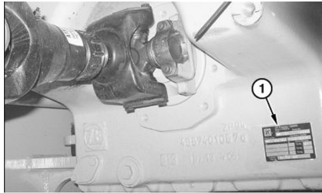
Ubicación de chapa de número de serie de transmisión
