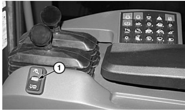
Interruptor de contador
