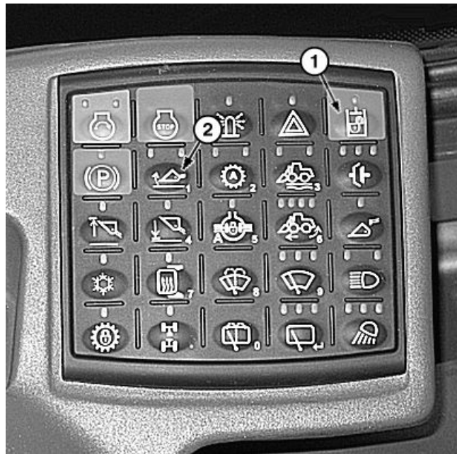
Interrupción para reanudar excavación (RTD)
