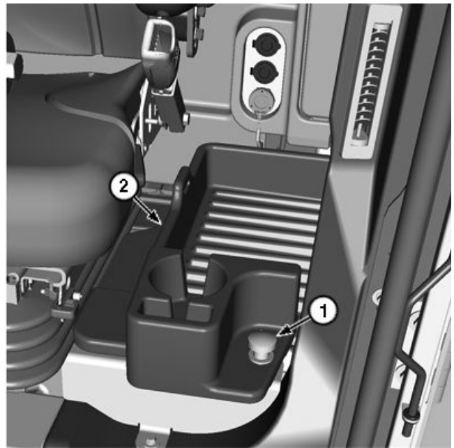
Cubierta del conjunto de filtros de aire
