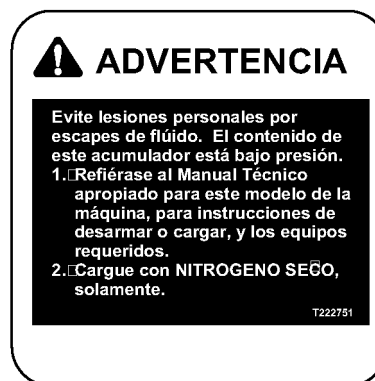
ADVERTENCIA: evitar lesiones debidas a escapes de fluidos
