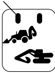
Interruptor selector de configuración de controles
