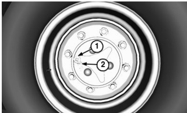
Tapón de llenado de la caja de planetarios de la TDM
