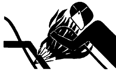
Нагревание линий, заполненных жидкостями под давлением
