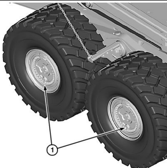
Ступица колеса на бортовом редукторе
