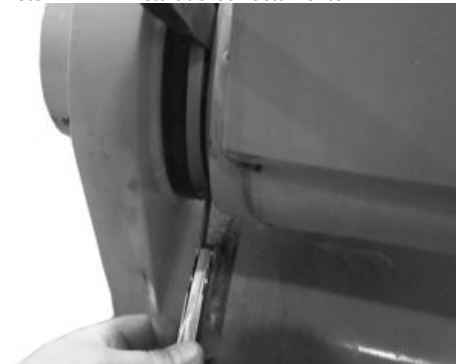
Medición de holgura axial de articulación y brazo de cuchara
