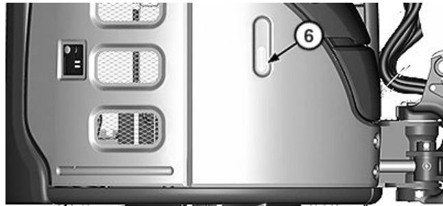
Tornillo de la válvula de vaciado del sistema hidráulico y mirilla de nivel de aceite (se muestra la máquina con cabina)
