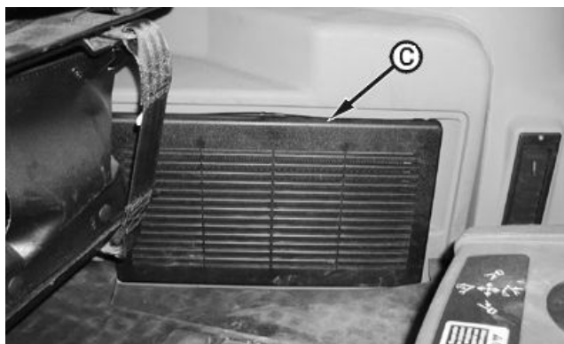
C—Cubierta del filtro de aire recirculado de la cabina
