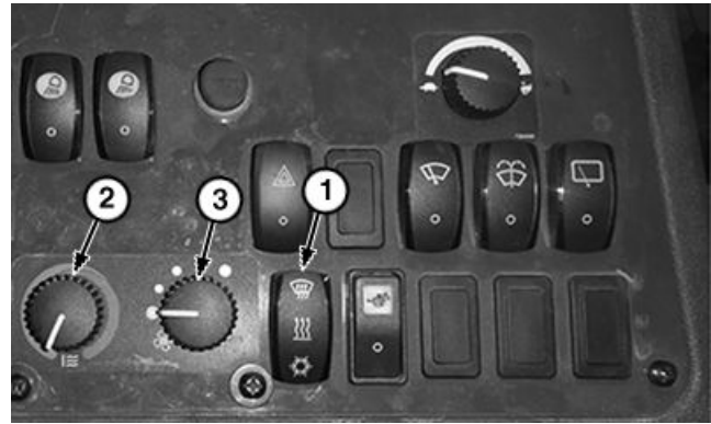
Controles del calefactor y aire acondicionado
