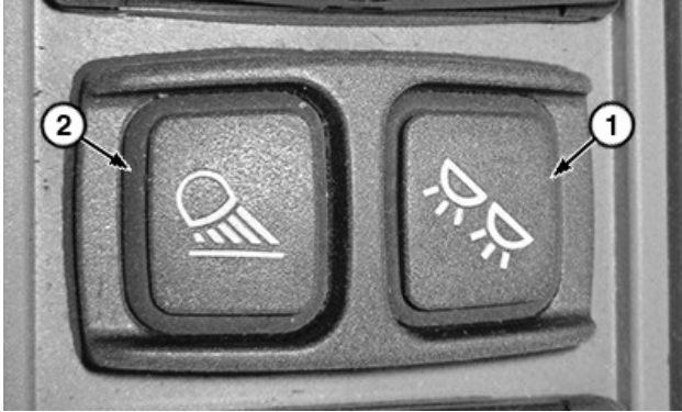
Interruptores de luces de servicio y de acceso (interruptores de consola)
