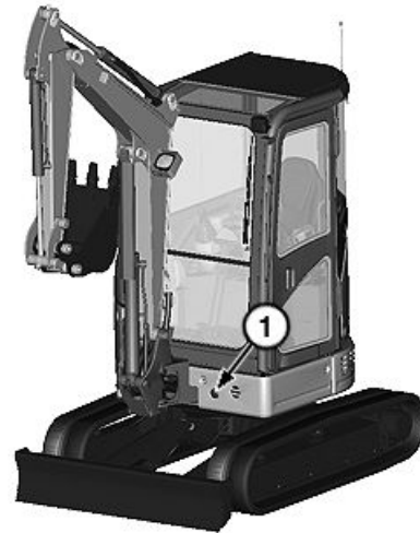
Válvula selectora de tubería auxiliar
