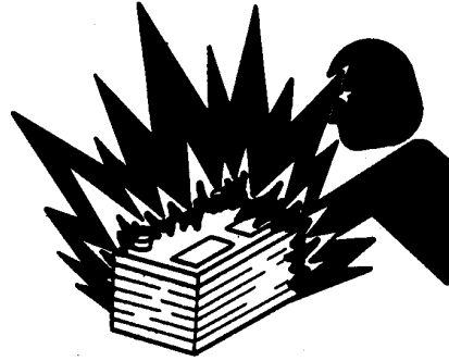
Explosión de gas de batería
