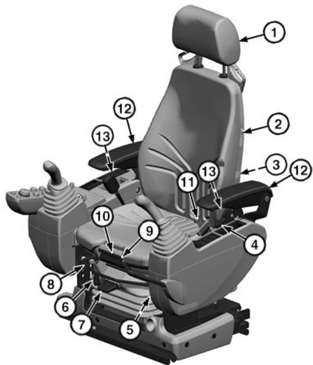
Asiento de suspensión neumática con calefactor y orificio de ventilación
