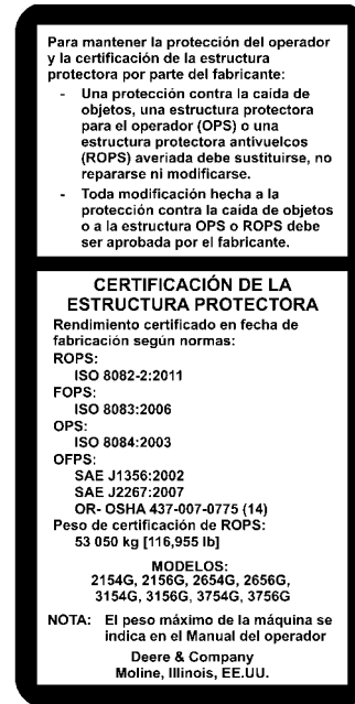
Certificación de la estructura protectora
