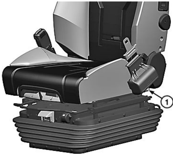
Tornillo izquierdo del cinturón de seguridad al asiento (se han retirado componentes para mayor claridad)
