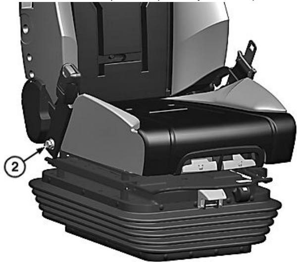
Tornillo derecho de la lengüeta de ajuste del cinturón de seguridad al asiento (se han retirado componentes para mayor claridad)
