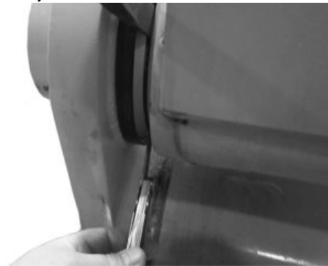
Medición de holgura axial de articulación y brazo de cuchara
