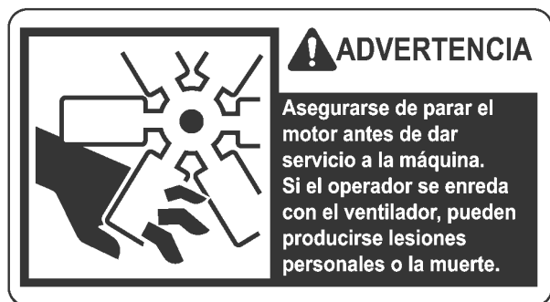
ADVERTENCIA: palas del ventilador en rotación
