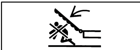
Abb 73. La estancia en la zona de viraje de la máquina está prohibida - ¡Peligro de sufrir lesiones!
