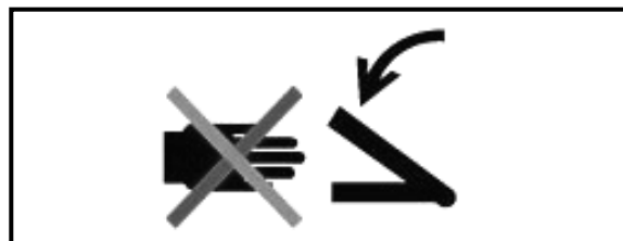
Abb 75. Existe peligro de aplastamiento - No introducir las manos en la zona de las partes móviles
