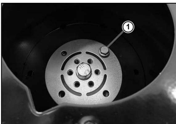
Abb 186. Posición del nuevo elemento de driveGUARD
