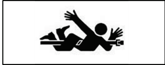
Abb 36. Gefahr des Erfassens und Aufwickelns an rotierenden Wellen
